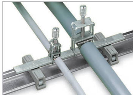
汇流条，带有2个接地脚 长度125 mm，汇流条与导轨平行 型号：790-115
